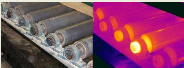
Superaquecimento de rolamento de esteira rolante
