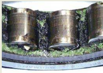
Degradação do lubrificante causada por descargas elétricas
