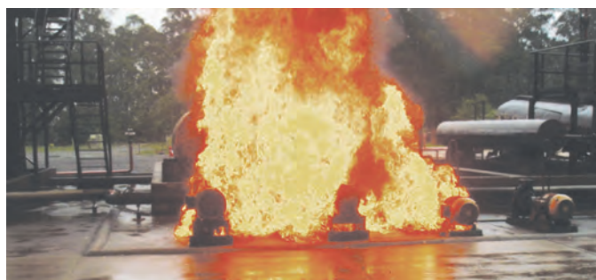
Os protetores foram submetidos a simulação de condições reais de incêndio em planta Petroquímica.
