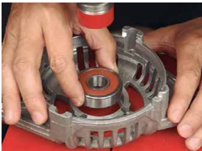
Montagem do rolamento do alternador
