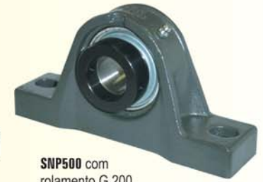
SNP500 com rolamento Y 200 T (fixação no eixo por colar concêntrico)
