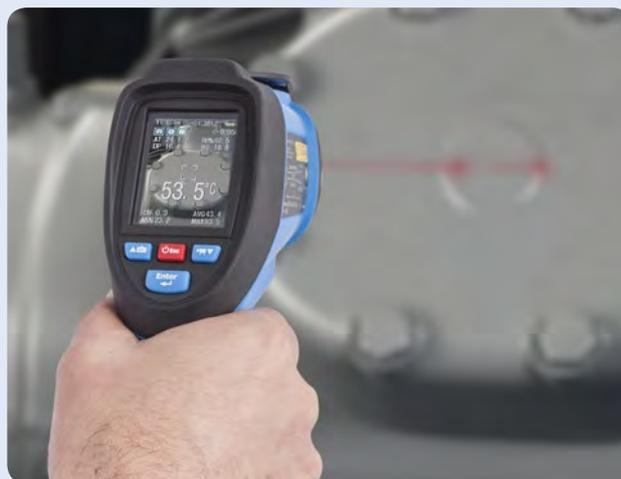
Quando usado no modo sem contato, o termômetro capta a energia térmica radiada por um objeto através de um detector infravermelho. Quando apontado em um objeto, o detector infravermelho coleta energia, produzindo um sinal que o microprocessador traduz como leitura no display com iluminação de fundo. Quando o gatilho é apertado, a temperatura do objeto é medida continuamente pelo detector infravermelho. Isso permite leituras rápidas e precisas, em tempo real.
