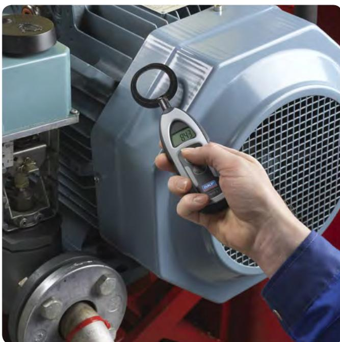
Os rolamentos dos motores elétricos acionados por controles de frequência variável ("Variable Frequency Drive", VFD) apresentam maior vulnerabilidade à erosão elétrica. Quando é incorporado ao programa de manutenção preditiva, a Caneta DDE pode ajudar a identificar os rolamentos mais suscetíveis à falha e evitar de modo significativo as interrupções não planejadas de funcionamento das máquinas.
