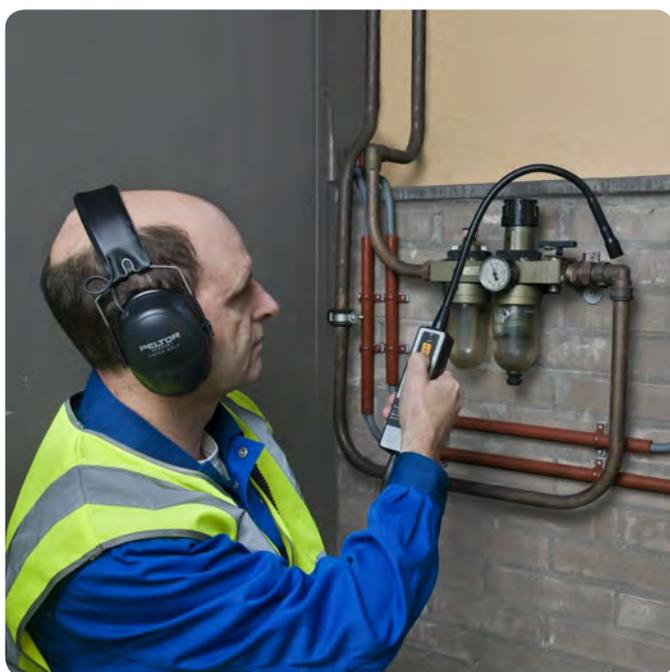
O TMSU 1 inclui um detector ultra-sônico, fone de ouvido, bico de borracha e baterias, todos fornecidos numa resistente maleta para transporte.
