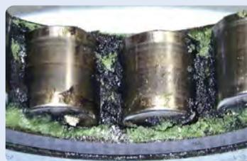
Degradação do lubrificante causada por descargas elétricas
