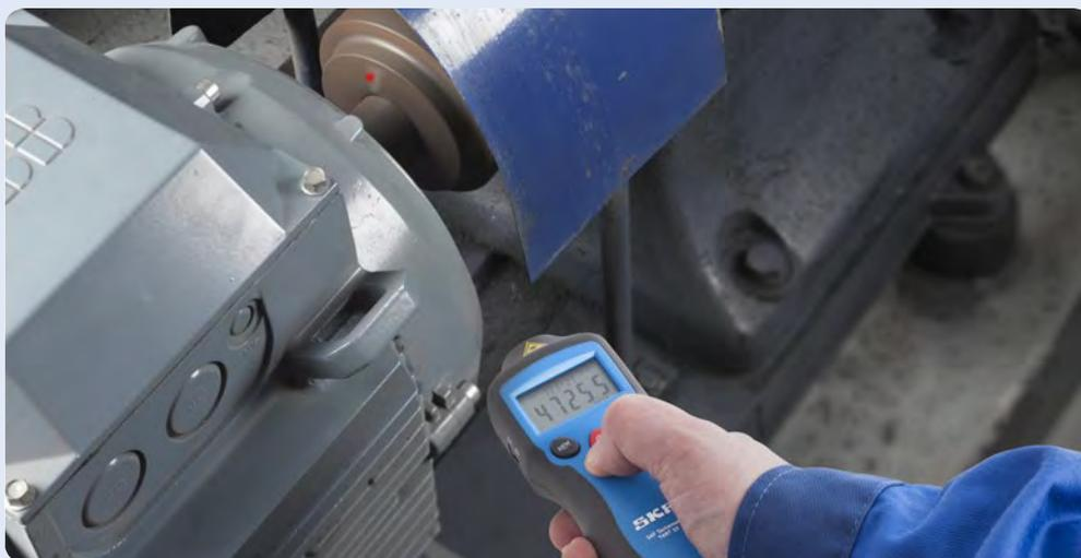
O sistema ótico a laser permite medições fáceis e rápidas a uma distância segura da máquina rotativa
