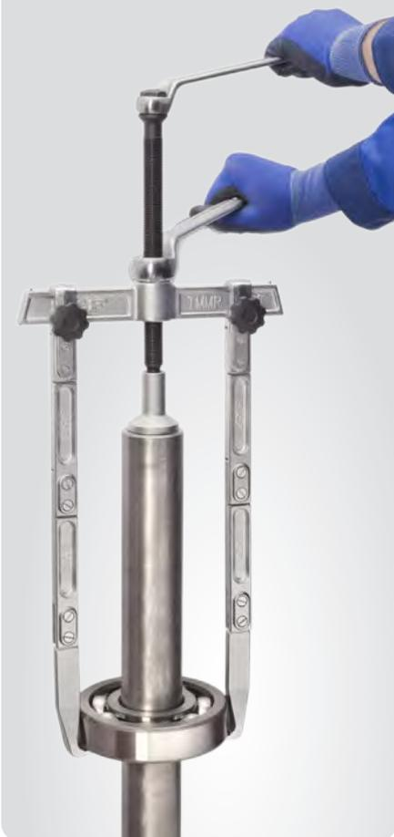
Extratores versáteis e robustos para tarefas de extração interna e externa
