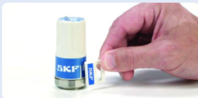
A chave de leitura magnética é incluída para a programação do Indicador de Condições de Máquina SKF. Ela é utilizada para ativar o Indicador de Condições de Máquina SKF, alterar os modos de operação, definir as linhas de base de vibração, reconhecer os alarmes e redefinir o Indicador de Condições de Máquina SKF.
