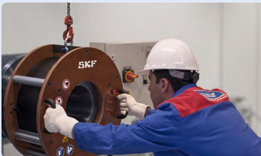
Os aquecedores EAZ de tamanho fixo são Aquecedores por indução SKF personalizados para desmontar anéis internos de rolamentos de rolos cilíndricos. Entre em contato com a SKF, para que possamos ajudar você a encontrar um aquecedor EAZ que seja indicado para sua aplicação. Os aquecedores EAZ são fornecidos sem painel de controle. É necessário ter painéis de controle SKF para operar o aquecedor EAZ de tamanho fixo. Eles podem ser encomendados separadamente.
