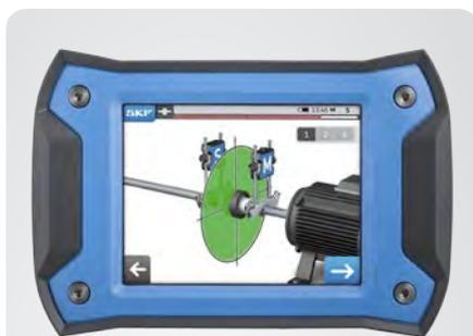
A medição livre permite que as medições de alinhamento comecem de qualquer ângulo e terminem com uma varredura angular de apenas 90°.
