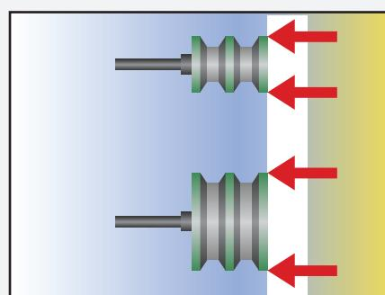
3. Conforme descrito na identificação, verificar o perfil das correias com os canais das polias. Como exemplo, Polias com canal “A” deve obrigatoriamente utilizar correia com perfil “A”, e assim por diante.
