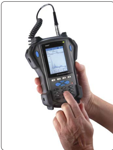
Maintenance conditionnelle des broches
